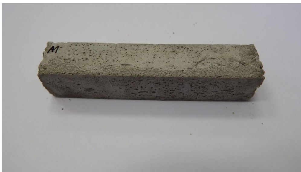
Obrázek 2 – Příklad vzorku používaného pro zjišťování fyzikálně-mechanických vlastností
