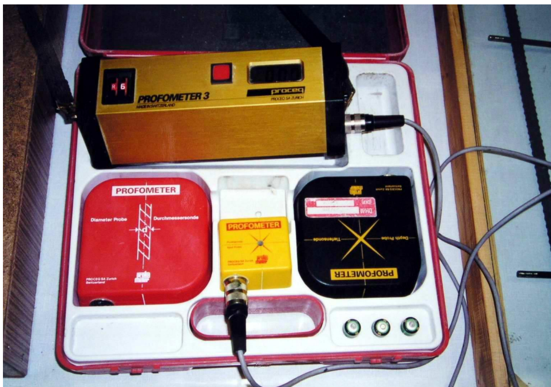
Obrázek 4: Profometer 3 z konce 80. let 20. století s průměrovou, bodovou a hloubkovou sondou.
