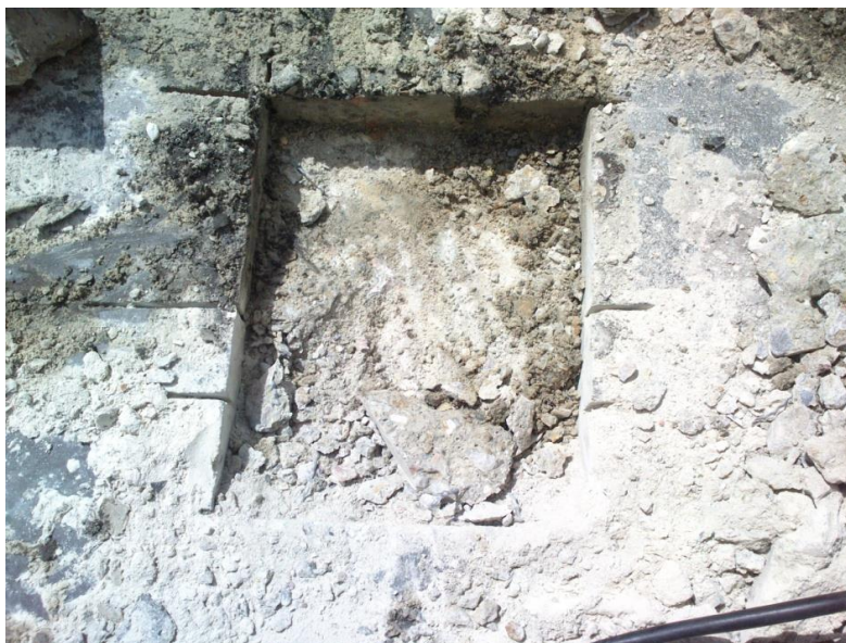
Obrázek 3.: Odběr vzorku pro RTG analýzu
