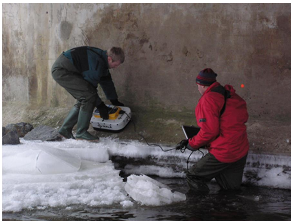
Obrázek 9: Problémem při využívání klasických georadarů při lokalizaci výztuže byly často i rozměry antény přístroje.
