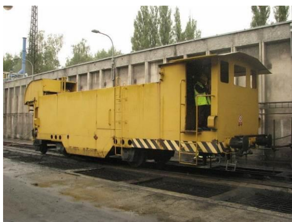
Obrázek 11.: Elektrovož jako zatěžovací prvek
