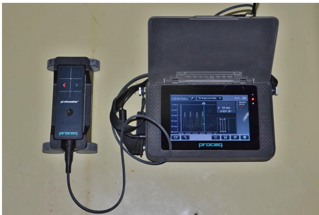
Obrázek 5: Profometer PM-630 s dotykovým displejem a integrovanou sondou; svítící šipky pomáhají lokalizovat výztuž, na displeji lze ihned kontrolovat správnost měření pomocí křivek intenzity signálu.
