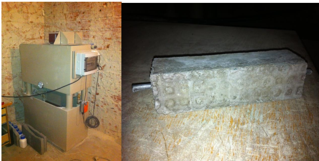
Obrázek 1 Zařízení pro cyklování a zkušební těleso s výztuží
