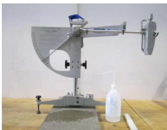
Obrázek 7: Kyvadlový přístroj pro měření drsnosti povrchu vozovky podle EN 1097-8
