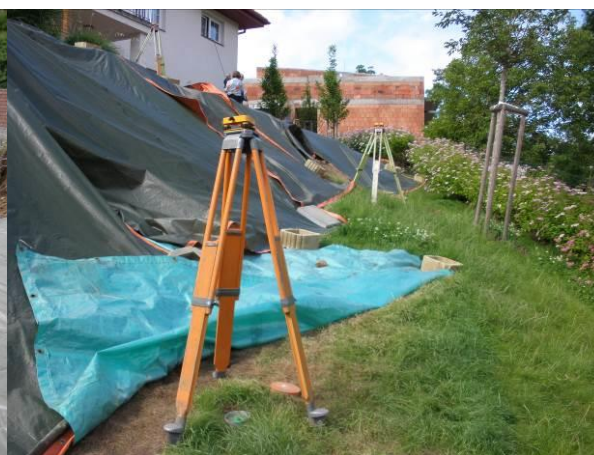
Obr. 10: Geodetické měření v místě poklesu a posunu svahu; viz Obr. 4, 9.
