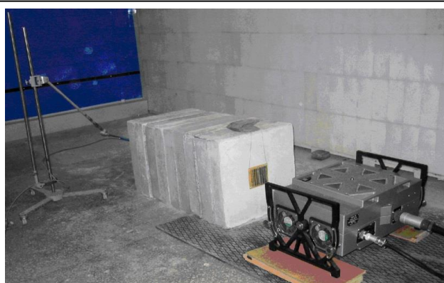
Obrázek 3.: Betatron MIB-7,5 MeV – umožňuje prozářit 1 m betonu
