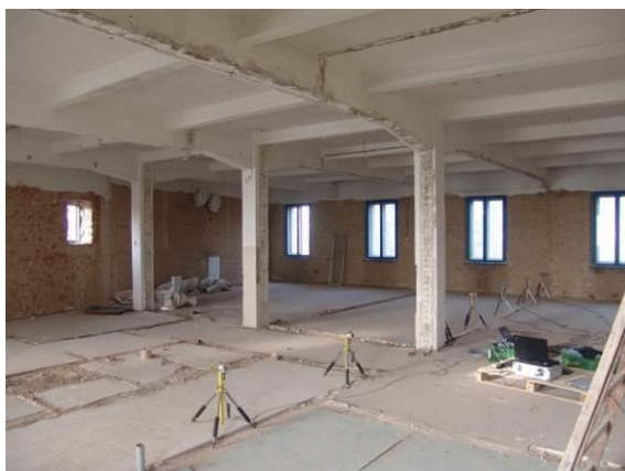
Obrázek 3.: Rozmístění potenciometrických snímačů dráhy
