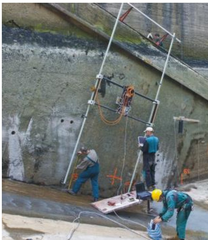
Obrázek 10: 3D skener DIBEKON firmy INSET s.r.o. představuje vrchol možností aplikace standardních georadarů v oblasti diagnostiky železobetonu (laskavě poskytnuto z archivu RNDr. Jakuba Štainbrucha, Ph.D.).
