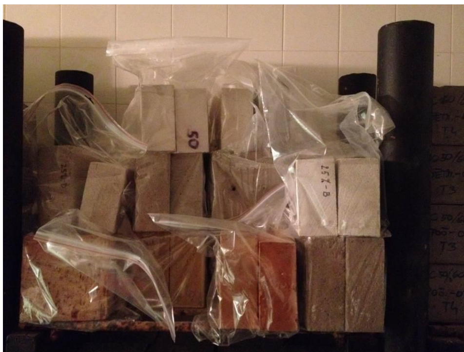
Obrázek 1.: Zkušební vzorky o různých vlhkostech s aplikovaným injektážním gelem a neprodyšně uzavřené v plastových obalech
