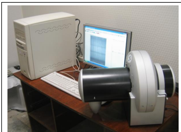
Obrázek 5.: Skener DÜRR pro vyhodnocování paměťových folií
