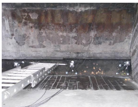
Obrázek 12.: Umístění snímačů dráhy v dolní části zásobníku
