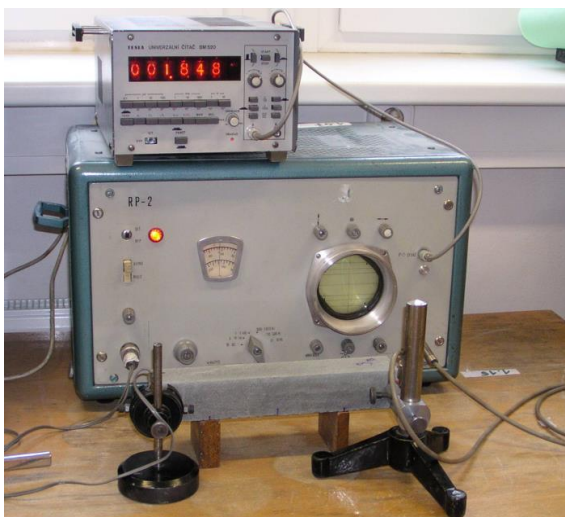
Obrázek 3: Porovnání staré a nové rezonanční metody – vlevo spojitá aparatura RP-2, vpravo impulsní snímač a Fourierův analyzátor frekvencí.
